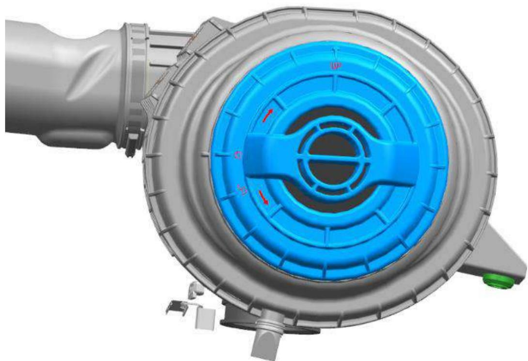
Пользователи CFORCE1000 NEW уже знают, что новый воздушный фильтр более удобен в обслуживании, фильтрующий элемент можно заменить без каких-либо инструментов. Улучшена эффективность забора воздуха, а сопротивление снижено с 7,4 кПа до 4 кПа.
