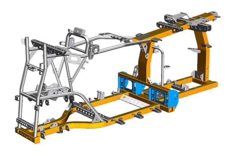
Как и на новых мотовездеходах серии CFORCE1000 NEW/LTD диаметр стальных труб рамы был увеличен, а благодаря прочному материалу (Cr-Mo) толщина стенок уменьшена. Оптимизация структуры рамы делает шасси на 8% легче, в тоже время на 20% выше по прочности и жесткости.
